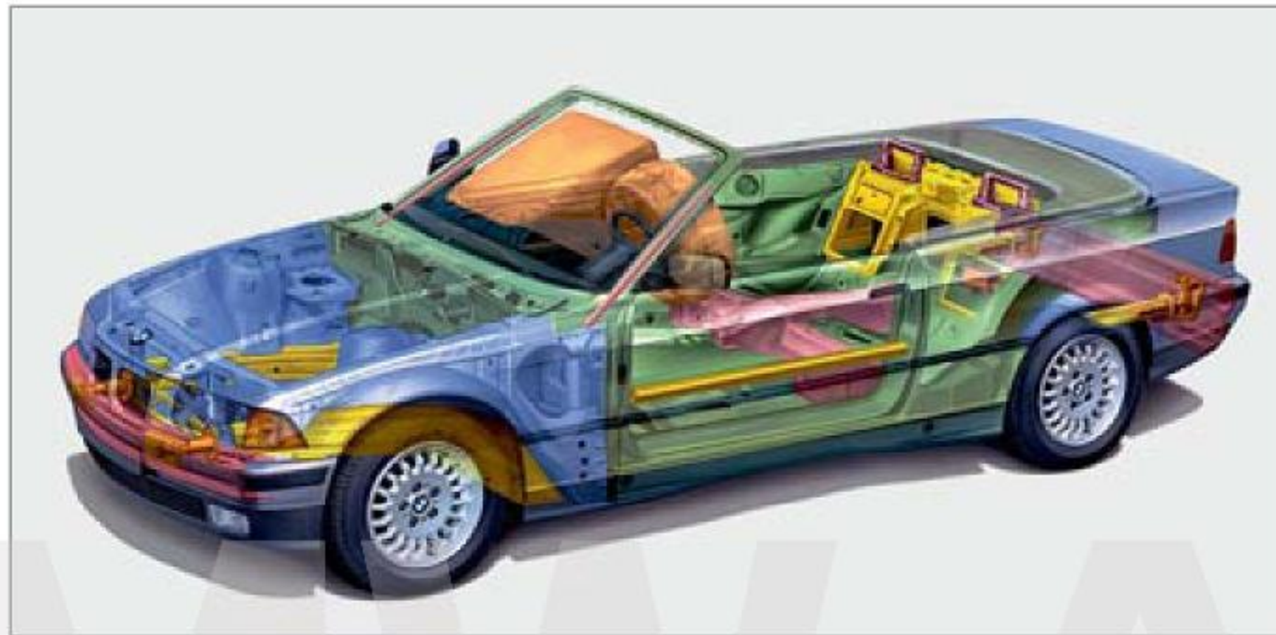
Sicherheit durch extrem steife Karosseriestruktur im BMW 3er Cabrio E36. Safety thanks to an extremely stiff body on the E36 BMW 3 Series Convertible.
