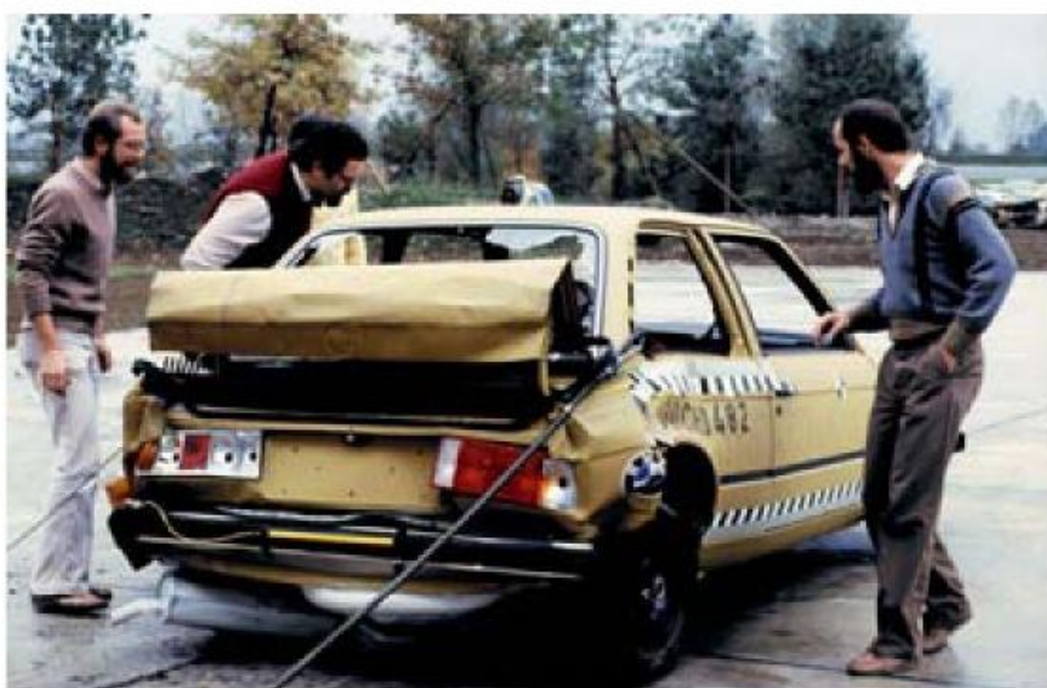
Heckaufprall-Simulation auf dem BMW Testgelände im Norden Münchens. Simulated rear-end impact at BMW's test site in the north of Munich.
