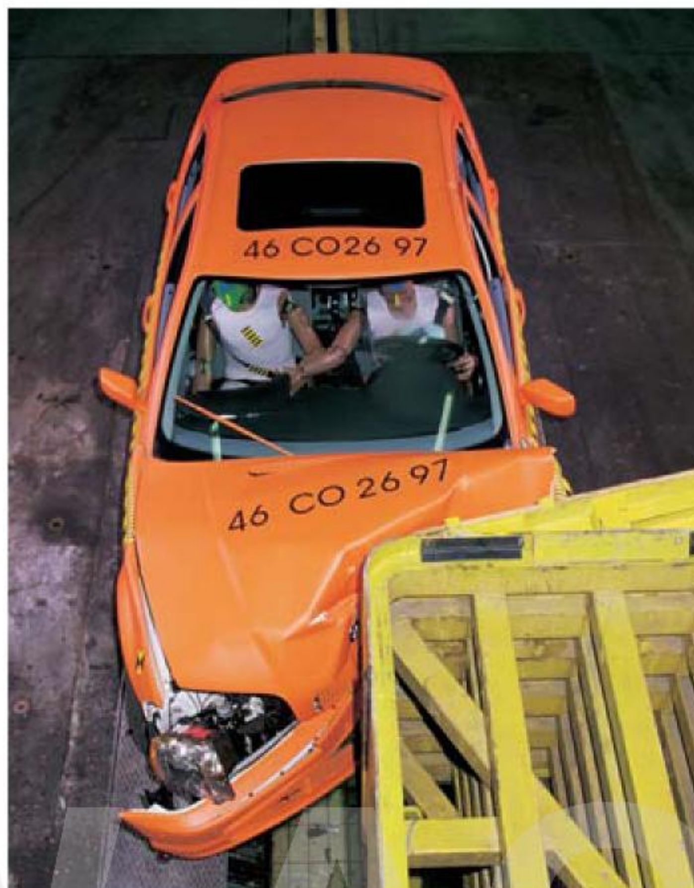
Simulation eines Front-Seit-Crashes im BMW Versuchsgelände. Simulated frontal side impact at the BMW test site.
