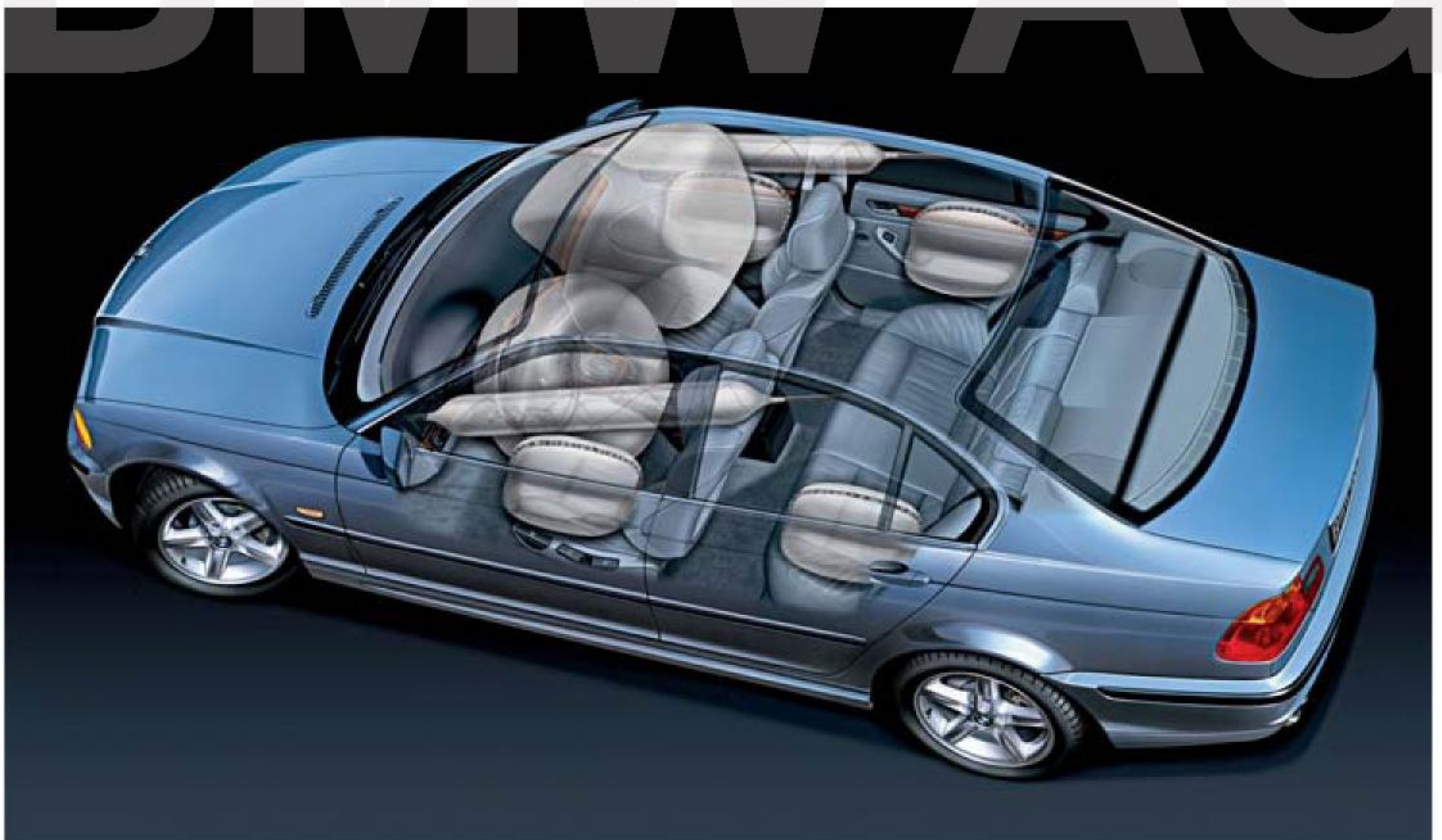
Sicherheit rundum in der der vierten Generation BMW 3er mit acht Airbags.
