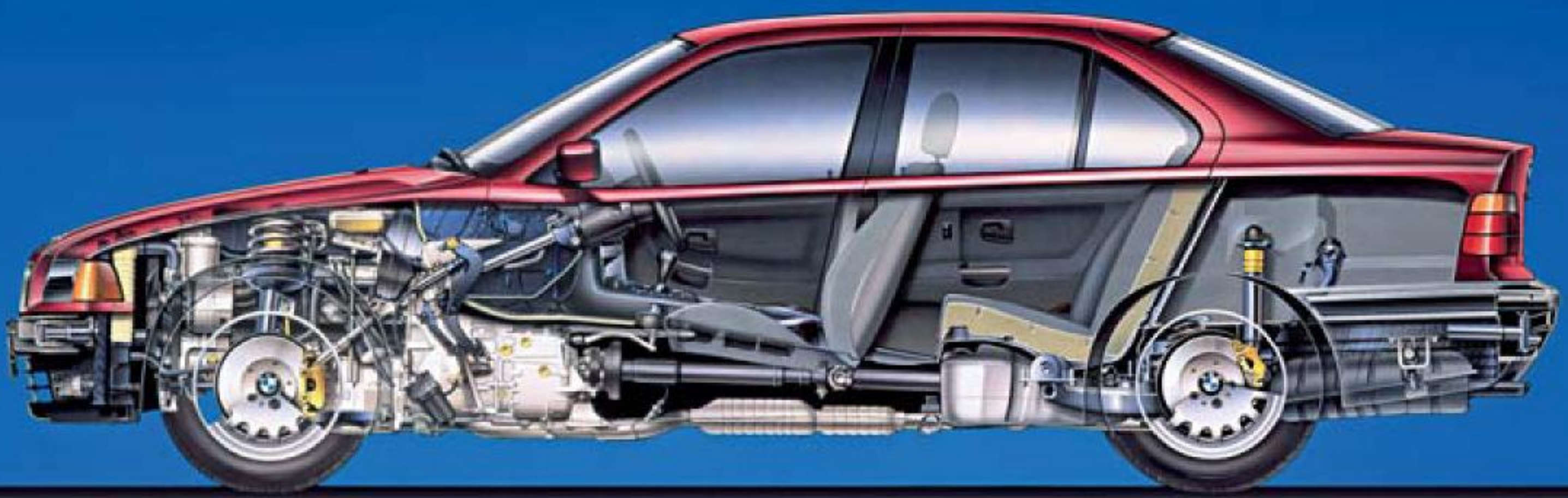
Innenansicht eines Weltstars: Längsschnitt durch die E36 Limousine. Inside view of a world star: longitudinal section of the E36 Saloon.
