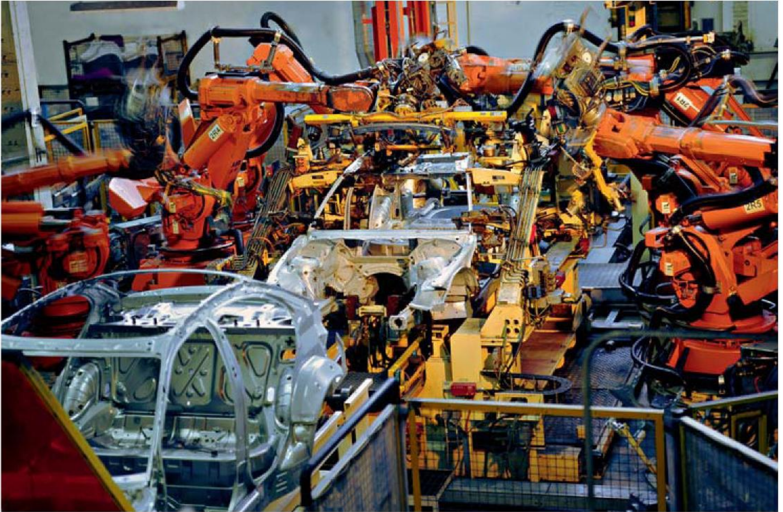
Vollautomatisch wird die Karosseriestruktur geschweißt. The body structure is welded in a fully automated process.
