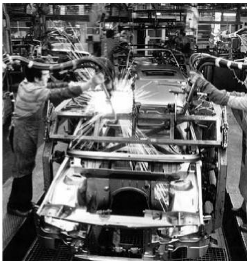
Schweißen der Karosseriestruktur im BMW Werk München.
