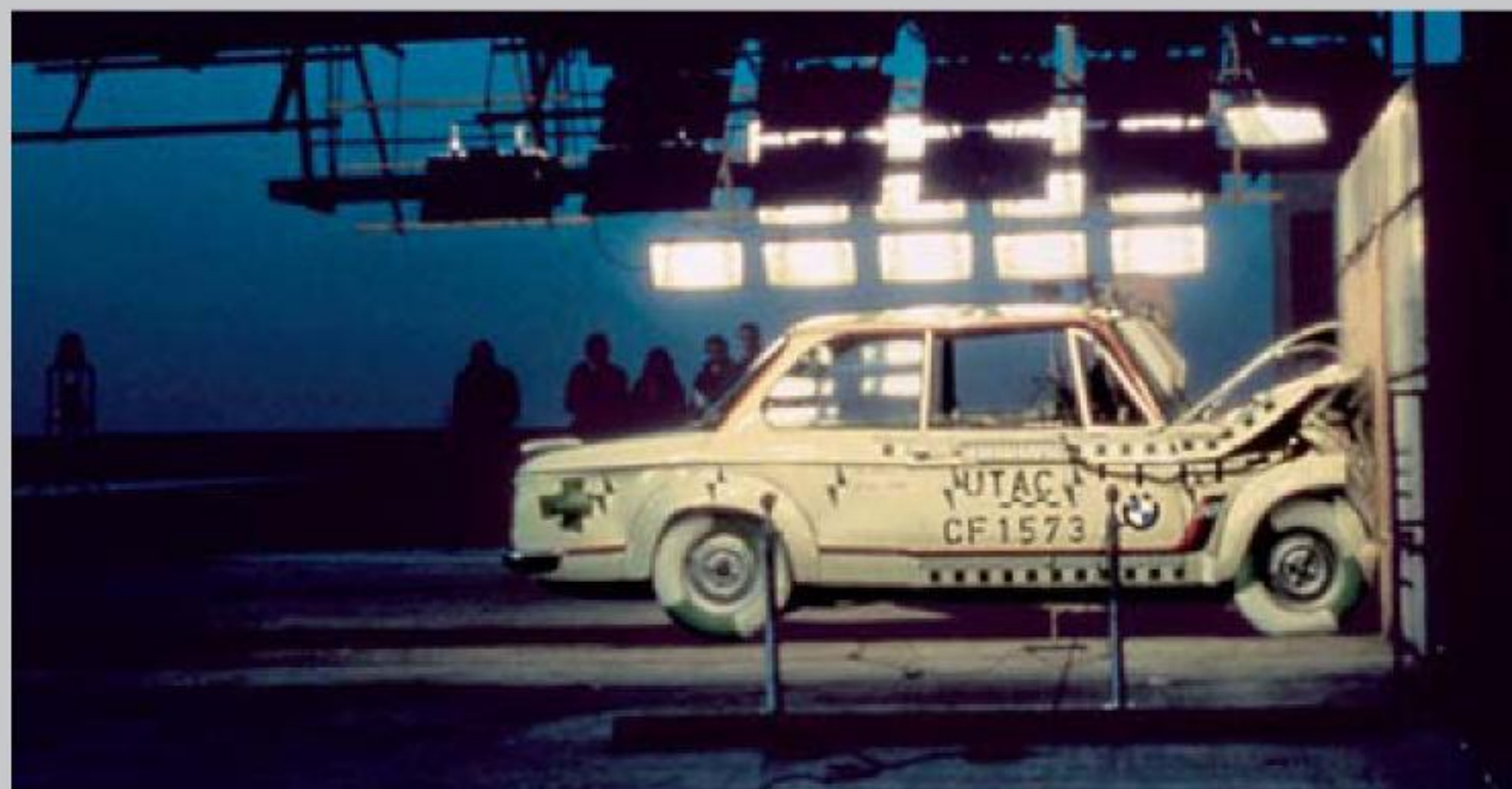
Intensiv wurde die passive Sicherheit der BMW 02er Fahrgastzelle getestet. The passive safety of the BMW 02 passenger cell was rigorously tested.
