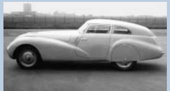
Der Gitterrohrrahmen für das Kamm-Coupé AM 1008 (links) war aus Elektron und wog nur 30 kg. Rechts das fertige Kamm-Coupé bei Testfahrten am Flughafen Oberwiesenthal.
