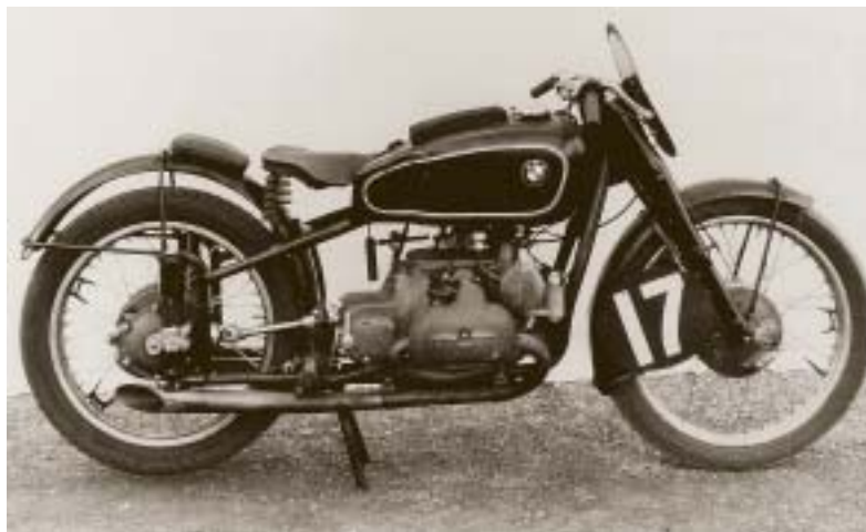
So erschien sie 1937 auf der Rennstrecke: die Kompressor-BMW erstmals mit Hinterradfederung.
