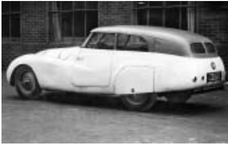
Die erste Limousine, das Projekt AM 1007, hatte Probleme mit dem Geradeauslauf.
